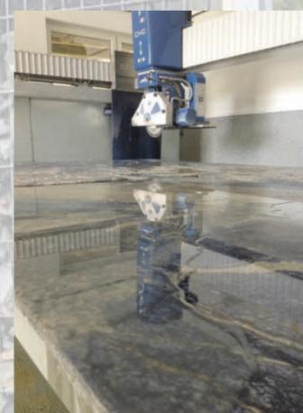
Mit modernen CNC-Schneid- und Fräsmaschinen können spezielle Ansprüche und Wünsche berücksichtigt werden. So lassen sich Ausschnitte, Rundungen und Vertiefungen auf den Millimeter genau realisieren.
